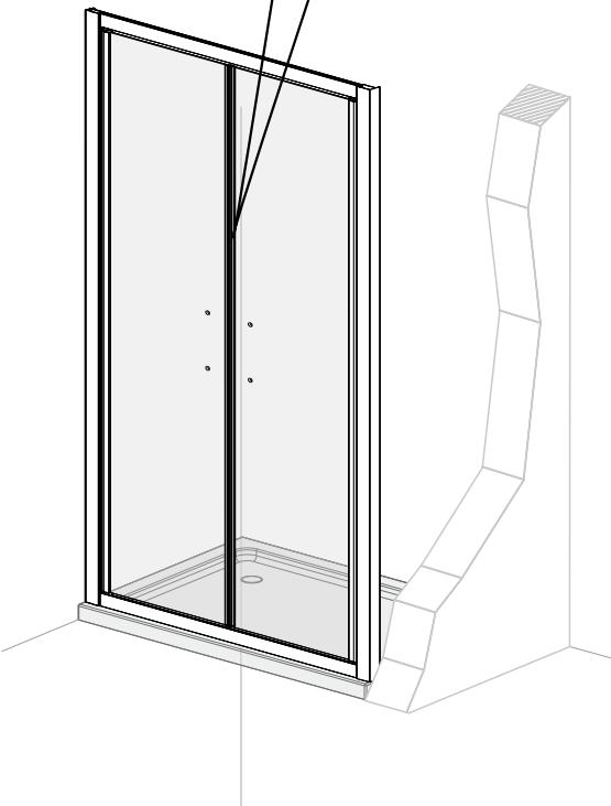
**IT Regolazione fine (se necessaria)** In caso di non perfetta chiusura dei magneti delle porte è necessario agire come da figura.
