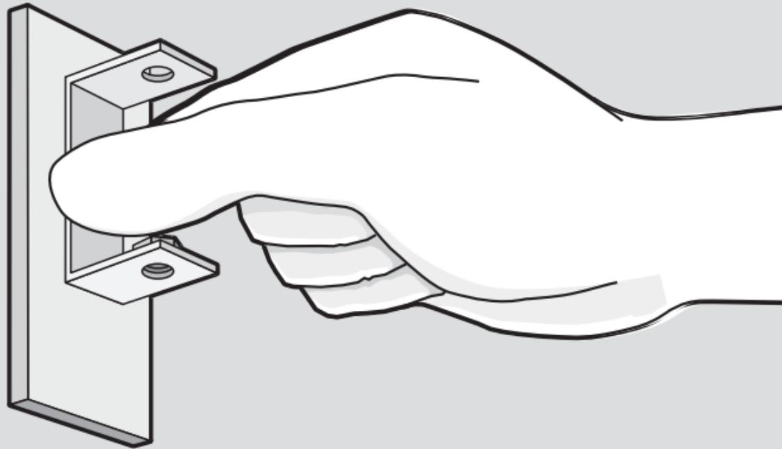
**D:** Wandhalter an die Wand andrücken. ZackMount kann je nach Witterung ca. 15 Minuten verarbeitet und korrigiert werden. Eventuell ausgetretenen Kleber am besten erst nach Aushärtung mit einem Cuttermesser entfernen, oder mit dem Finger abrubbeln.
