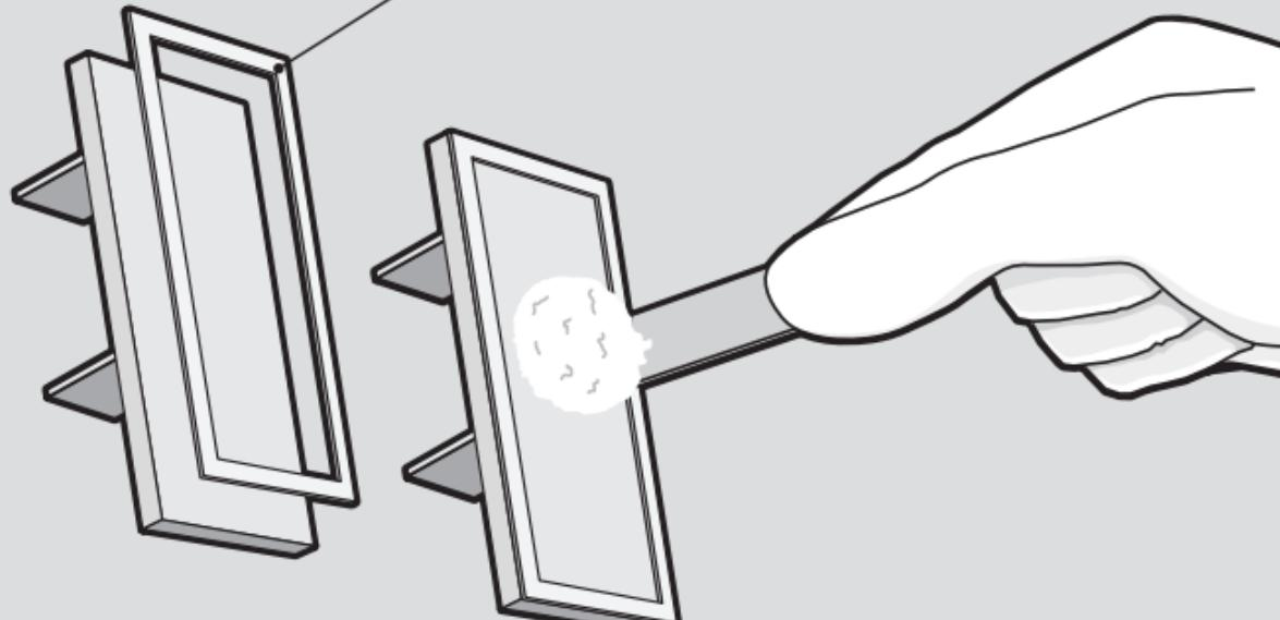
**D:** Einseitig selbstklebenden Kunststoffrahmen auf die Rückseite des Wandhalters kleben. Angemischtes ZackMount-Haftmittel mit dem Spatel mittig auf die Montageplatte auftragen. Für die Verarbeitung des Klebers (nicht im Lieferumfang enthalten) beachten Sie bitte die dem Kleber beiliegende Bedienungsanleitung.
